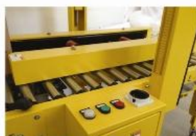
مجهز به تابلو برقی و کلید قطع اضطراری
